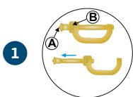
Pressione simultaneamente as travas A e B (conforme ilustração) do conector e, em seguida, puxe para trás para abrir.
