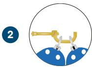
Após aberto, coloque o olhal dos trava-quedas no conector.
