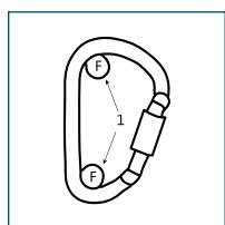
**A carga deve ser aplicada sobre o eixo maior do conector, como mostra a figura ao lado. Se a carga for aplicada sobre o eixo menor, pode ocorrer a redução da resistência do conector.**
