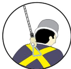
**3)** Conecte o conector do trava-quedas retrátil na argola dorsal.
