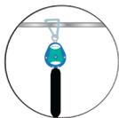
3) Conecte o trava-queedas em um ponto de ancoragem confiável.
