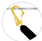
6) Conecte o conector de cada trava-queedas em um ponto de ancoragem confiável.
