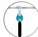
6) Conecte o conector de cada trava-queedas em um ponto de ancoragem confiável.
