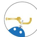
**3)** Conecte o olhal do travaquedas, no conector que faz parte do sistema.
