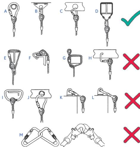
Exemplos de métodos corretos e incorretos de conexão com um ponto de ancoragem ou posição.
