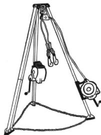
**9 -** Posicione, através do sistema de pinos e travas o sistema 3way e o guincho nas hastes do tripé. O 3way deverá ser posicionado pelo lado externo da haste lateral ao olhal, o qual foi posicionado o cabo do mesmo, e o guincho pelo lado interno da haste mais próxima ao olhal central (procedimento para que não haja atrito entre as partes, cabo de aço/haste).
